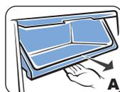
O Compartimento Turbo no congelador e o compartimento Fresh Food no refrigerador são compostos de uma bandeja e uma tampa. A bandeja é deslizante e a tampa é basculante. Puxe a bandeja para frente para acessar os alimentos armazenados e a tampa será aberta pelo deslocamento da bandeja (FIGURA A).
