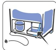
Seu refrigerador possui um coletor de água localizado na parte traseira próximo ao compressor (motor). A função do coletor é armazenar água do degelo automático que evapora através do calor gerado naquela região.
